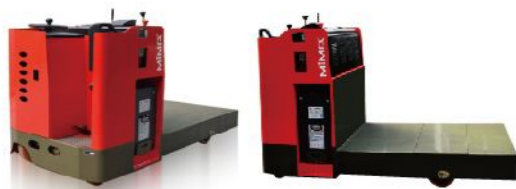
ME100 / 固定平台/ 10吨 电动 / 单驱 / 平台尺寸定制 / 站驾式
