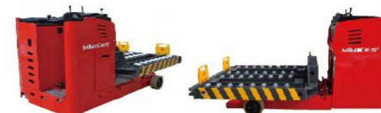
ME-A100 / 起升平台/ 10吨 电动 / 单驱 / 平台尺寸定制/站驾式
