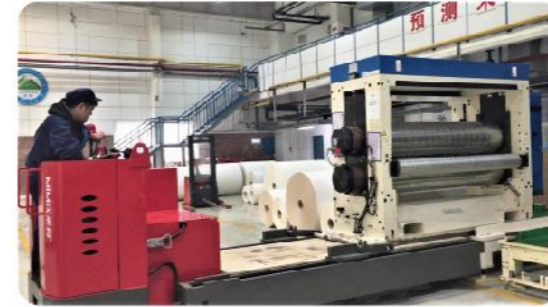
纸业 / 印刷 / 印染模具搬运及更换 / 16T 电动 / 起升平台 / 室内 / 室外
