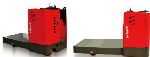
ME120 / 固定平台/ 12吨 电动 / 单驱 / 平台尺寸定制 / 站驾式
