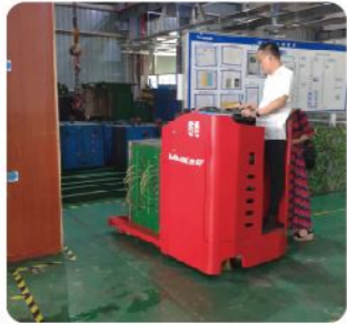
卫浴行业 / 注塑模具搬运 / 6T / 电动 / 固定平台 / 室内
