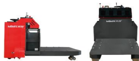
ME-A80 / 起升平台/ 8吨 电动 / 单驱 / 平台尺寸定制/站驾式
