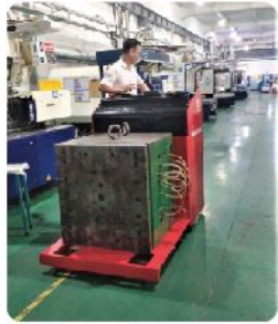
卫浴行业 / 注塑模具搬运 / 6T / 电动 / 固定平台 / 室内
